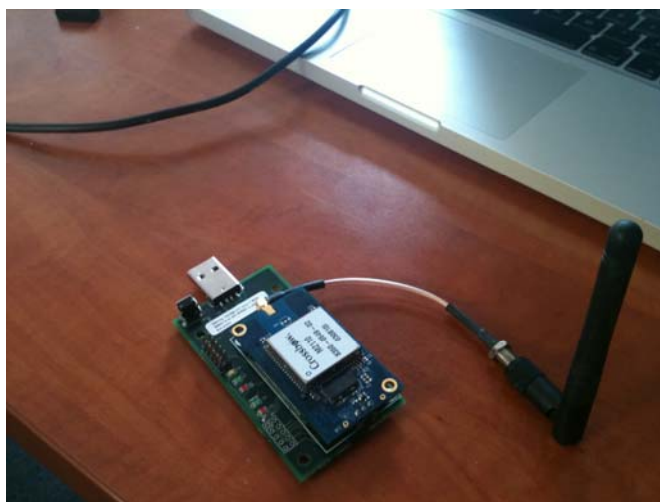
Figura 6 Stația de bază wireless
