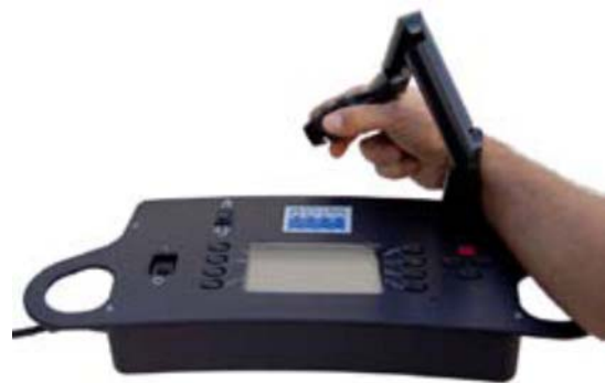
Fig. 4.2. Consola de comanda de la suprafață a brațului robotic TITAN-4
