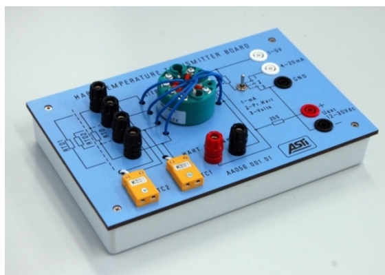
Fig 1.12. Traductorul SITRANS TH 300 montat pe suportul de lucru
